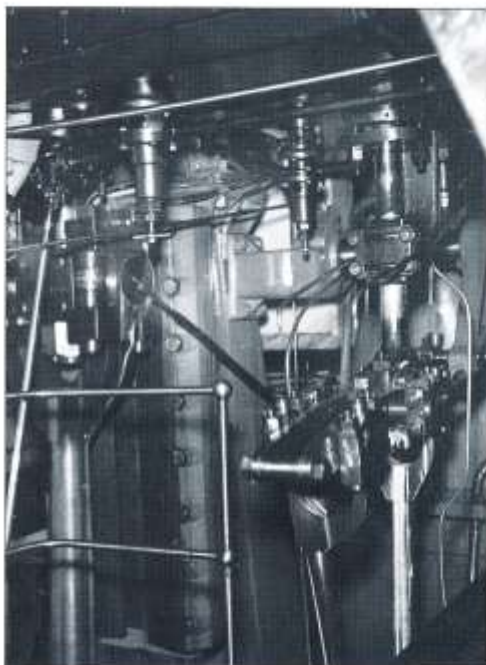
Foto från mellangreningen i ATLEs aktra maskinrum som visar lågtrycks-cylinderns roterande och kullsläddar.
