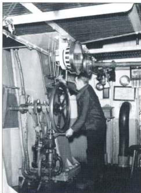
Okänd maskinist kör omkastningsmaskinen vid ATLEs aktra maskin. Oranjer för hans huvud syns maskintelegrafin och iskällertelegrafin för förliga maskinen.
